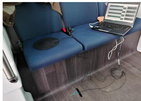
Instrumentation du véhicule automatisé avec des accéléromètres
